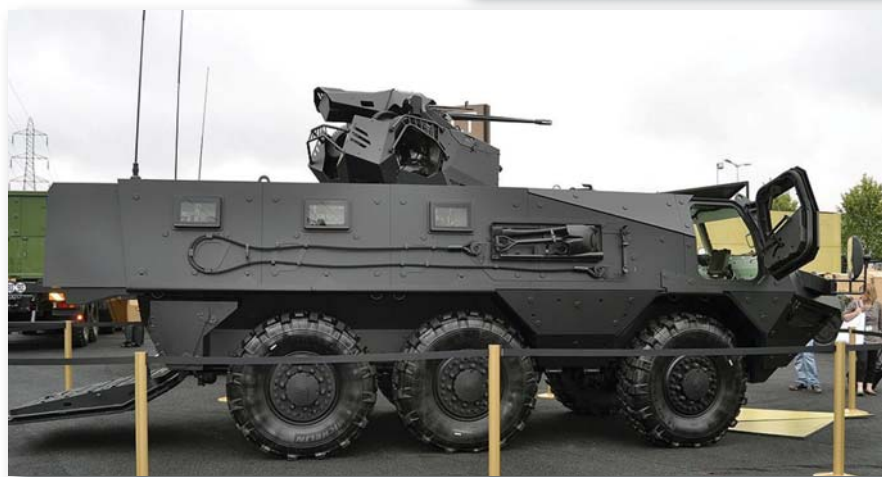
Код возила VAB Mk 3 примећна је другачија конфигурација ходног дела и ширанији шруи
